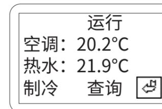
当机组发生故障时，蜂鸣器鸣叫报警，主界面右下角“查询 $\rightarrow$ ”会连续闪烁（如左图），此时按“ $\rightarrow$ ”键，即可进入“当前故障查询界面”，如下图所示，同时蜂鸣器将不再蜂鸣提示。
